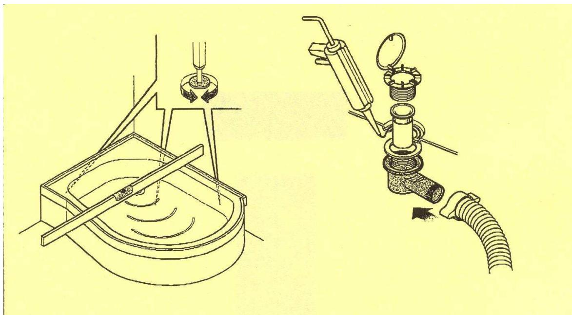
**1** Haal de douchebak uit zijn verpakking. Plaats deze waar hij moet staan en zet waterpas door de stelvoeten in of uit te draaien. Controleer ook de uitlijning ten opzichte van de muur.
