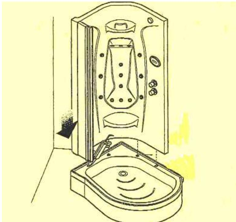
**3** Haal de kolom uit de verpakking. Spuit silicone op de rand waar de kolom geplaatst word; evenwel vóór de bevestigingsschroeven.(zie tekening). Bevestig de kolom met de bijgeleverde zelfborende schroeven.
