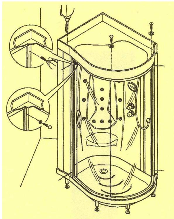
**10** Controleer de positie van de deur ten opzichte van de douchebak en dak. Bevestig de douchedeur in de compensatieprofielen met 2 + 2 schroeven 0,39 x 16,4 en pvc afdekkopjes. Regel de wieltjes van de schuifdeur door de excentrieken af te stellen.
