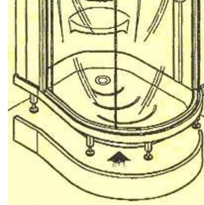
**13** Positioneer de cabine in de hoek en ga na of alles naar behoren functioneert. Om de cabine stevig vast te zetten volstaat het in de opstaande zijrand van het dak langs iedere kant een gaatje te boren en in de muur te bevestigen met schroeven.
