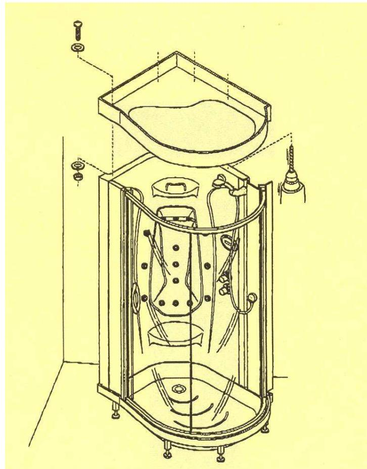
**9** Neem het dakelement uit de verpakking en leg dit op de cabine. Centreren en bevestigen door middel van de zelfborende schroeven.
